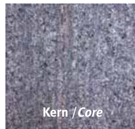
Bild / Fig. 2: Gefüge des 20MnCrMo7 / Microstructure (Vergr./Magn. 100:1)
