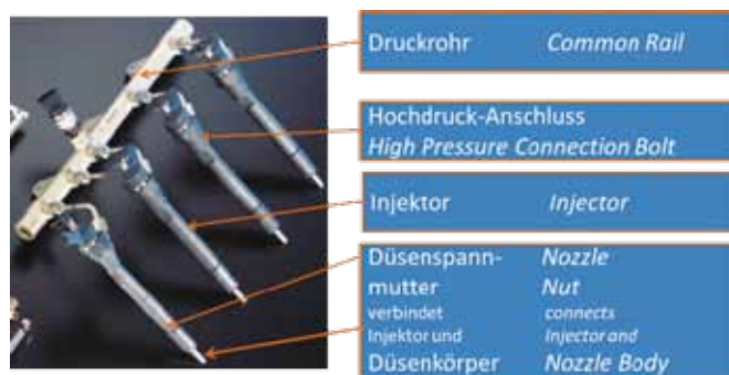
Bild / Fig. 11: Einsatzmöglichkeiten für 20MnCrMo7 am Common Rail / Possible applications of 20MnCrMo7 in common rail systems
