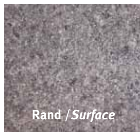
Bild / Fig. 2: Gefüge des 20MnCrMo7 / Microstructure (Vergr./Magn. 100:1)
