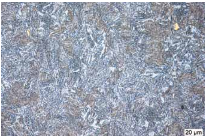
Bild / Fig. 6 : Titancarbonitride in duktiler bainitischer Matrix (Vergrößerung 500:1) / Titanium carbonitrides embedded in ductile bainitic matrix (Magn. 500:1)
